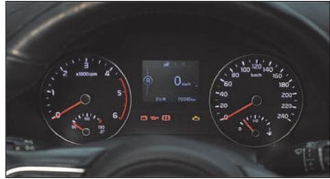
Bild 2.4: Wegmessung mittels Kombiinstrument
